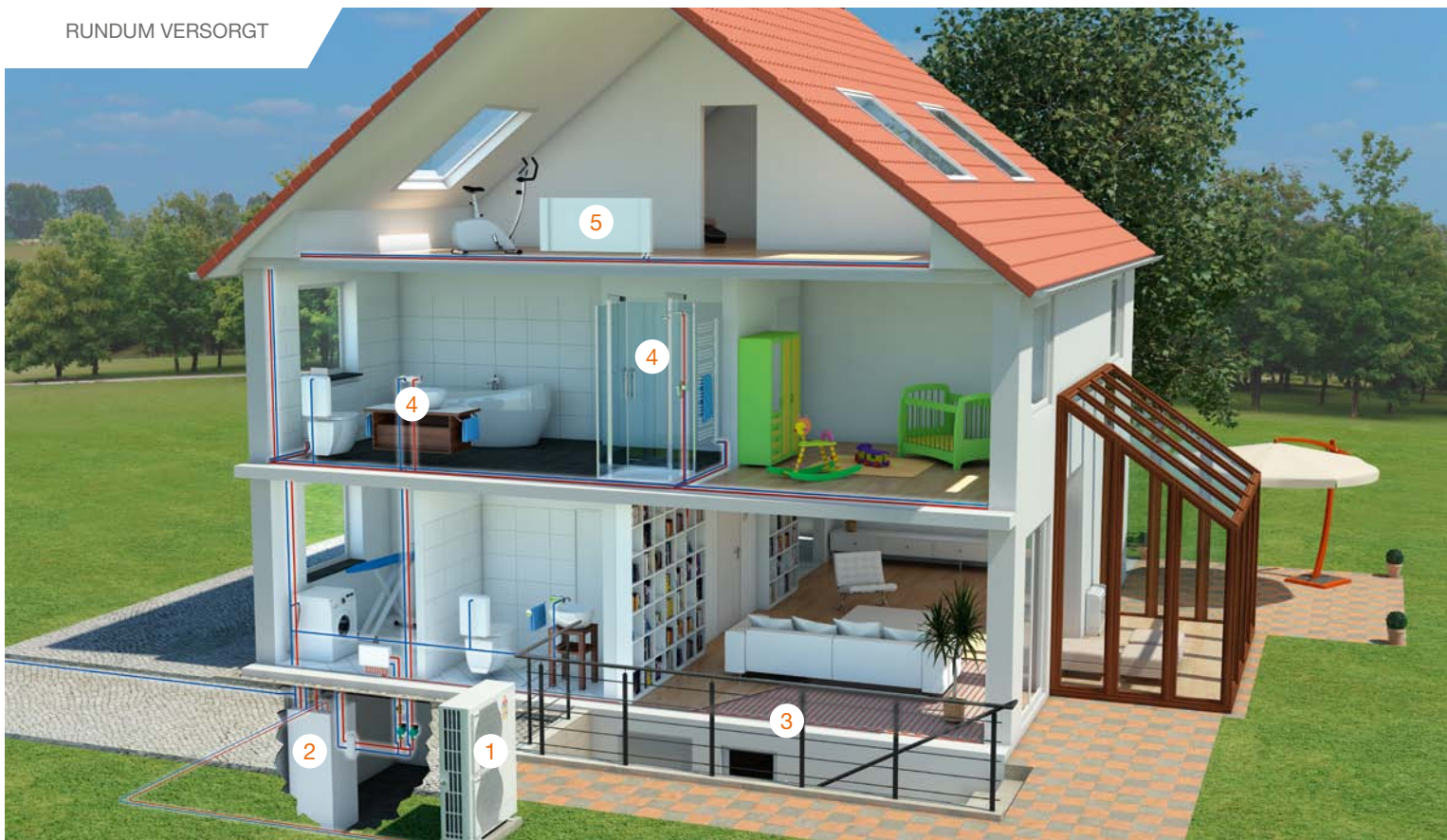
Ecodan-System: 1 Zubadan-Wärmepumpe, 2 Trinkwasserspeicher Bauseitig: 3 Fußbodenheizung, 4 Warmwasserversorgung, 5 Heizkörper
